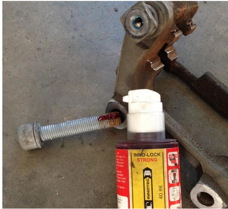
Inno-Lock ist eine starke, anaerobe Gewindegewissung auf Gelbasis, die eine einfache und saubere Verarbeitung ermöglicht, gleichzeitig abdichtet und vor Korrosion schützt.
