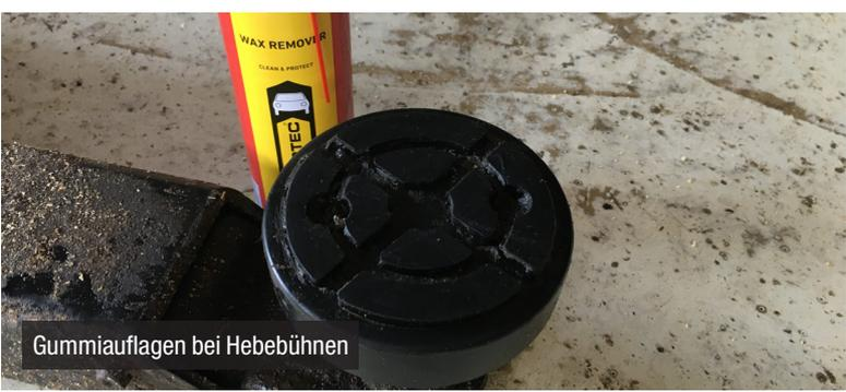
Gummiunterlagen bei Hebebühnen
