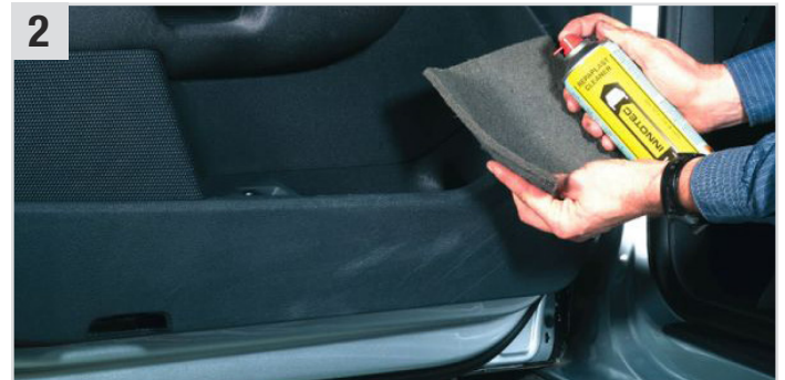
2 Repaplast Cleaner Antistatic (Kunststoff-Reiniger) auf das Shine P 600 (Schleifvlies) aufsprühen & das zu rep. Teil damit aufrauen - anschl. mit einem Multi Wipes Tuch (Universaltuch) trocken wischen (ca. 5 Min. ablüften lassen).
