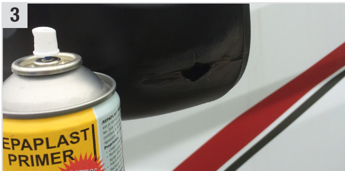
3 Repaplast Primer New Formula (Kunststoff-Haftvermittler) auftragen (ca. 10 Min. ablüften lassen).
