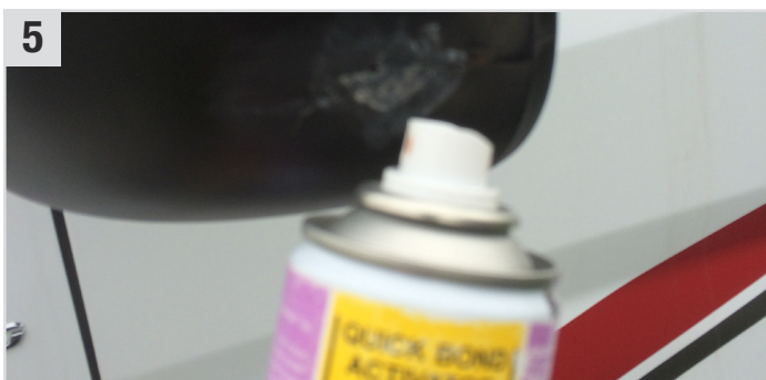
5 ... anschließend Quick Bond Activator (Sekundenkleber-Beschleuniger) aufsprühen.
