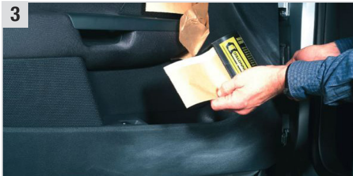
3 Mit Masking Paper Dispenser (Abdeckpapier) abdecken.
