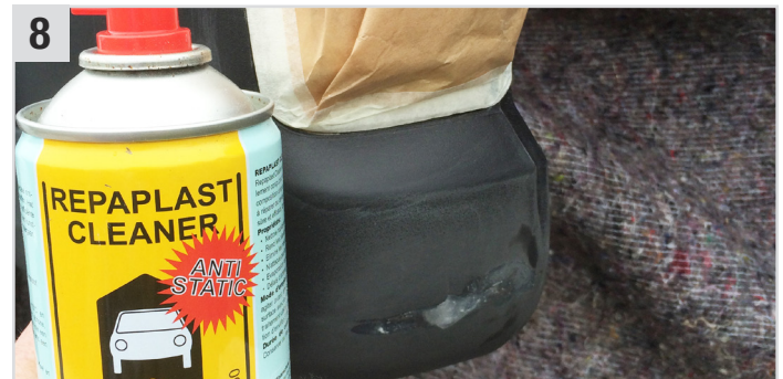
8 Die zu behandelnde Stelle nochmals mit Repaplast Cleaner Antistatic (Kunststoff-Reiniger) und Multi Wipes Tuch (Universaltuch) reinigen (ca. 5 Min. ablüften lassen).
