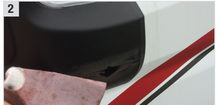
2 Die zu behandelnde Stelle mit K120 anschleifen und anschließend mit Repaplast Cleaner Antistatic (Kunststoff-Reiniger) und Multi Wipes Tuch (Universaltuch) reinigen (ca. 5 Min. ablüften lassen).
