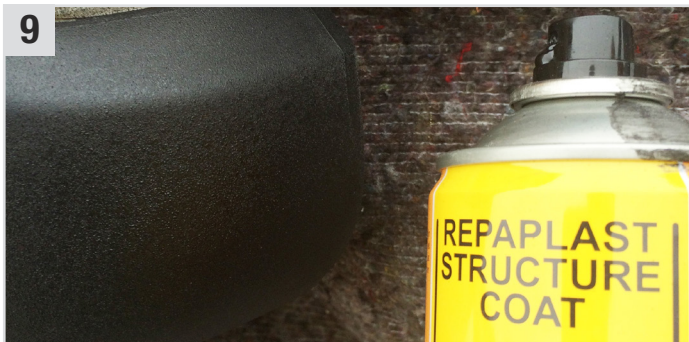
9 Repaplast Structure Coat NF (Strukturspray) bis zur gewünschten Struktur (eventuell in mehreren Schichten) auftragen (ca. 5 Min. ablüften lassen).
