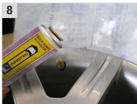
8 Danach zwei dünne Schichten Quick Bond Activator (Sekundenkleber-Beschleuniger) aufsprühen (Aushärtezeit verkürzt sich auf ca. 1 Minute).
