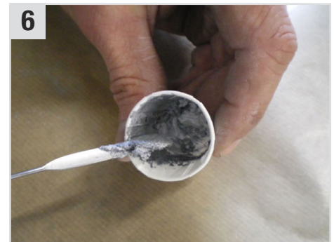
6 Alu Powder (Alupulver) und Quick Bond (Sekundenkleber) mit Hilfe der Spatula 1 (Alupulver) : 10 (Sekundenkleber) zu einer homogenen Masse vermischen.
