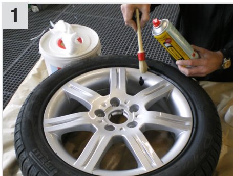
1 Felge von grobem Schmutz befreien und anschließend mit Repaplast Cleaner Antistatic (Kunststoff-Reiniger) mit Hilfe eines Pinsels entfetten...
