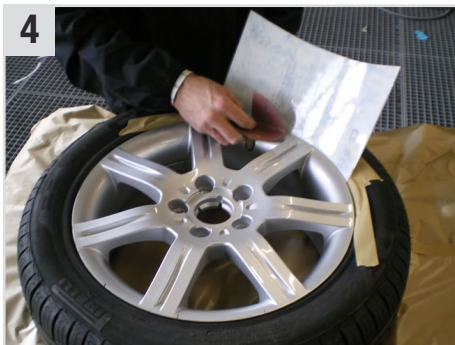
4 Beschädigte Stelle(n) mit P220 schleifen, dann mit P320 und zuletzt mit P400 nachschleifen.
