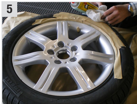
5 Mit Repaplast Cleaner Antistatic (Kunststoff-Reiniger) und Multi Wipes Tuch (Universaltuch) reinigen. (Hinweis: Sind nach dem Schleifen keine Beschädigungen erkennbar, bitte mit Schritt 12 fortfahren)
