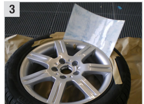
3 Den Reifen im Bereich der Beschädigung mit Masking Plate (Schablone) und/oder Abdeckpapier abdecken.
