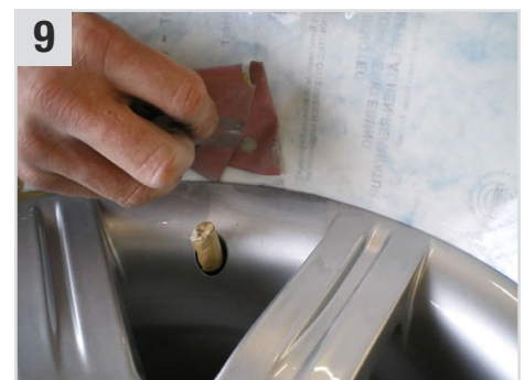
9 Reparierte Stelle(n) mit P220 schleifen, dann mit P320 und zuletzt mit P400 nachschleifen.
