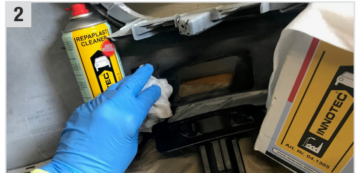
2 Die Klebestelle und die Parksensoren mit Repaplast Cleaner Antistatic (Kunststoff-Reiniger) und Multi Wipes (Universaltuch) gut reinigen und ca. 5 Min. ablüften lassen.
