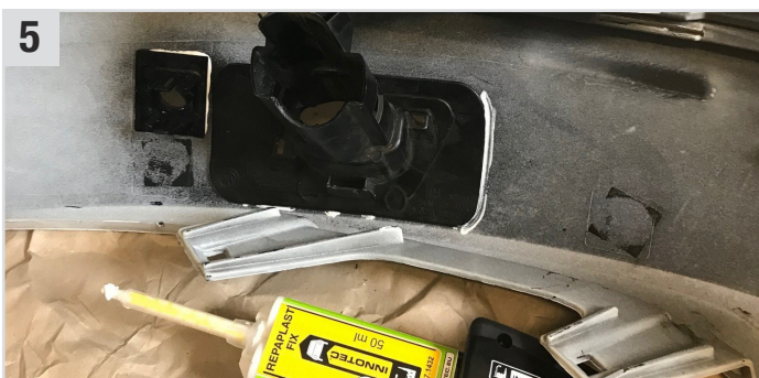
5 Repaplast Fix (2K-PU-Klebstoff) ist nach 35 Sekunden griff trocken und bereits nach 1 Stunde durchgehärtet.
