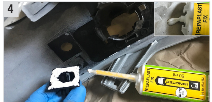
4 Vor dem Aufsetzen der Mixer Nozzle Gelb PRO (2K-Mischdüsen) kontrollieren, dass beide Komponenten von Repaplast Fix (2K-PU-Klebstoff) rauslaufen und anschließend die gewünschte Verklebung der Parksensoren vornehmen.
