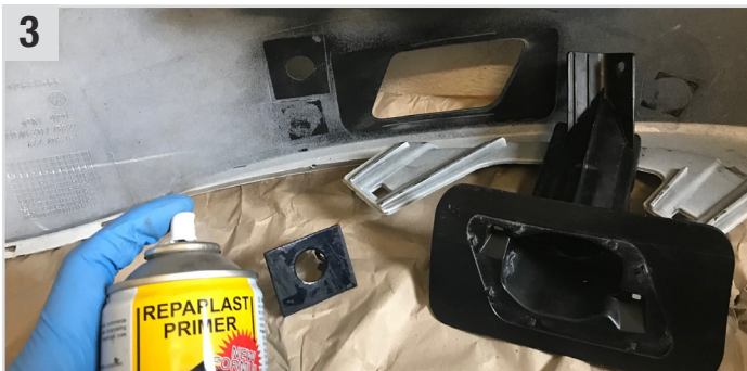
3 Eine dünne Schicht Repaplast Primer (Kunststoff-Haftvermittler) auf die Klebestellen und Parksensoren auftragen und ca. 10 Min. ablüften lassen.
