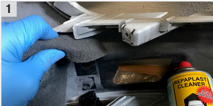
1 Repaplast Cleaner Antistatic (Kunststoff-Reiniger) auf Shine P 600 (Schleifvlies) geben und damit evtl. Lacknebel von Klebefläche entfernen.
