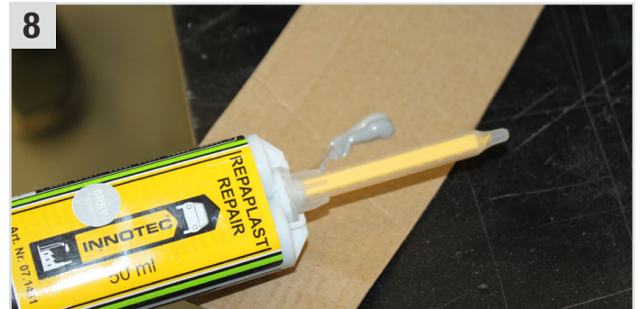
Kontrolle der Funktionalität der Doppelkartusche, indem vor dem Aufsetzen der 2K-Mischdüse mithilfe der entsprechenden 2K-Pistole Material herausgedrückt wird (beide Komponenten müssen rauslaufen).
