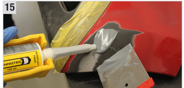
15 ... mit der Repaplast Finish Nozzle (2K-Mischdüsen für Repaplast Finish) direkt auftragen .
