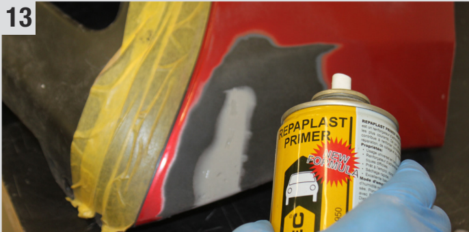
13 Eine dünne Schicht Repaplast Primer (Kunststoff-Haftvermittler) auftragen und ca. 10 Min. ablüften lassen.
