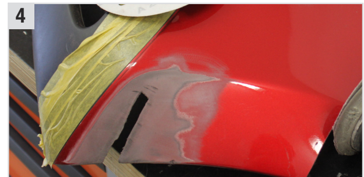
4 Auf der Außenseite des Stoßfängers den Riss großflächig mit Royalcut (Runde Klettdisketten) K120 anschleifen.
