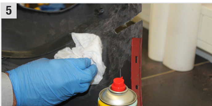
5 Nochmals Außenseite und Innenseite mit Repaplast Cleaner Antistatic (Kunststoff-Reiniger) und Multi Wipes (Universaltuch) gut reinigen und trockenwischen (ca. 5 Min. ablüften lassen).
