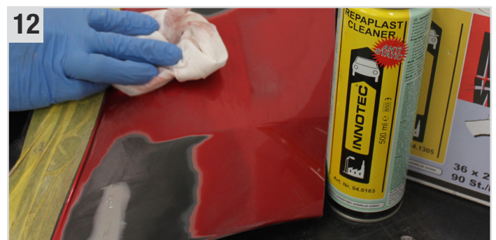
Im Anschluss nochmals mit Repaplast Cleaner Antistatic (Kunststoff-Reiniger) und Multi Wipes (Universaltuch) reinigen und trocken nachwischen (ca. 5 Min. ablüften lassen).
