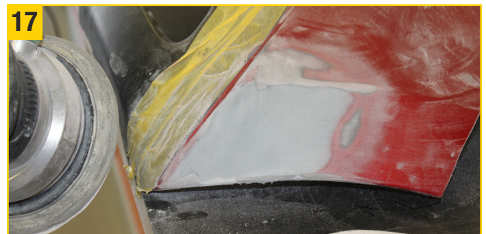
17 Repaplast Finish (2K-Kunststoffkitt) mit Royalcut (Runde Klettdisketten) K120, K220 und K320 schleifen - weitere Schritte laut Lackhersteller. Fertig!
