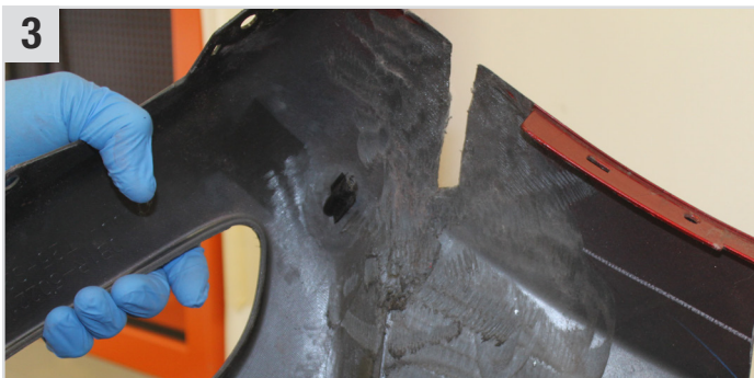
3 Riss auf der Innenseite mit Winkelschleifer (Fächerscheiben K60 oder K80) großflächig aufrauen.
