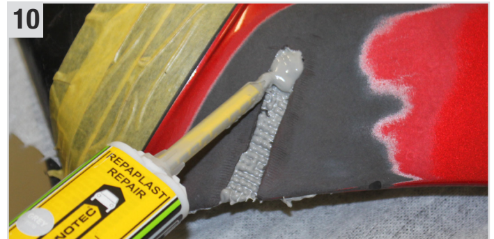
Anschließend die Rissstelle auf der Außenseite ebenfalls mit Repaplast Repair (2K-Kunststoffkleber) ausfüllen. Dann ca. 15 Min. aushärten lassen.
