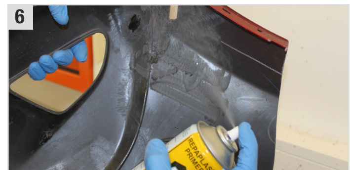
6 Dünne Schicht Repaplast Primer (Kunststoff-Haftvermittler) auf Vorder- und Rückseite anbringen (ca. 10 Min. ablüften lassen).
