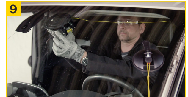
9 Austrennwerkzeuge neu positionieren, wenn die Trennschnur die obere linke Ecke erreicht hat. (Dach- und Armaturenbrettschoner während des gesamten Vorgangs verwenden/anbringen)
