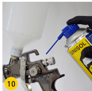
10 Lackierpistole außen reinigen.
