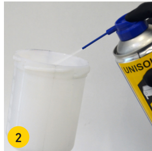
2 Farbbecher innen, von oben nach unten reinigen.
