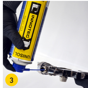
3 Pistole herumdrehen und Farbverschmutzungen ausspritzen (Luftzufuhr minimal eingestellt lassen).
