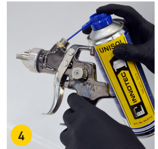
4 Restfarbe von oben ausspritzen (Luftzufuhr minimal eingestellt lassen).
