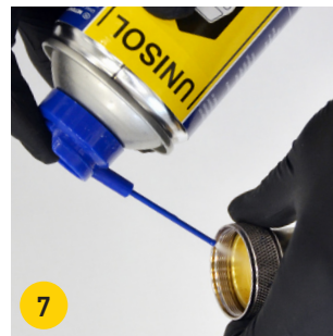
7 Restfarbe von vorne ausspritzen. Pistole vorne leicht nach unten neigen.
