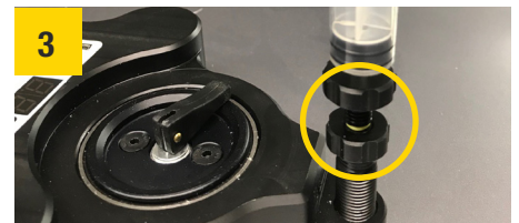
3 Zum Vakuum erzeugen, muss gelber Ring sichtbar sein (max. 2-mal)
