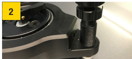
2 Injektor reindrehen bis die Schadstelle mit dem Reparatur-Harz - Nr. 1 gefüllt ist
