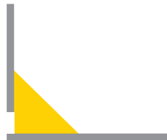
Richtig: Gerade Dichtfuge (1 Kartusche = ca. 7 Lfm)
