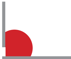
Falsch: Pralle Dichtfuge
